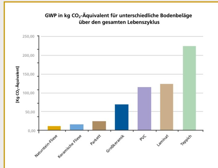
Bei der Untersuchung der für höchstbelastete Bodenbereiche verwendeten Beläge wurde festgestellt, dass sich im Vergleich zur Betonwerksteinplatte für die Naturwerksteinplatte in allen Wirkungskategorien niedrigere Äquivalenzwerte ergeben. So ist der GWP einer Naturwerksteinplatte um ca. 27 % geringer als der einer Betonwerksteinplatte und ca. 74 % geringer als der einer Großkeramik.
